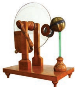
Електростатичка машина , крај 19, почетак 20. века Материјал: Дрво, стакло, метал. Димензије: 41 × 26 цм. Педагошки факултет у Сомбору, Сомбор
