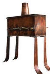
Уређај за испитивање топлотне проводљивости чврстих тела , крај 19, почетак 20. века. Материјал: Метал. Димензије: 25 × 10 цм. Педагошки факултет у Сомбору, Сомбор
