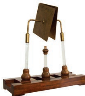
Плочасти кондезатор , крај 19, почетак 20. века Материјал: Дрво, стакло, метал. Димензије: 37 × 15 цм. Педагошки факултет у Сомбору, Сомбор
