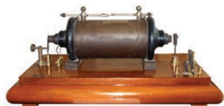
Рункорфов индуктор , крај 19, почетак 20. века Материјал: Дрво, метал. Димензије: 67 × 37 цм. Педагошки факултет у Сомбору, Сомбор
