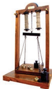
Електромагнет (са котвом и тасом) , крај 19, почетак 20. века Материјал: Метал, дрво. Димензије: 70 × 35 × 34 цм. Педагошки факултет у Сомбору, Сомбор
