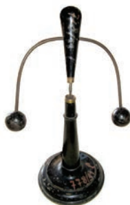
Уређај за демонстрацију стабилне равнотеже , крај 19, почетак 20. века Материјал: Дрво, метал. Димензије: 37 цм. Педагошки факултет у Сомбору, Сомбор
